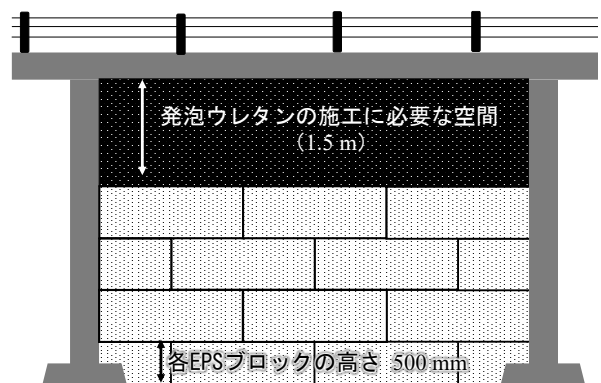
図-2 FS工法の中詰め状態
