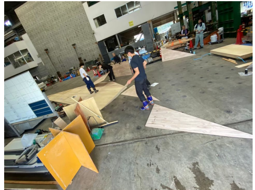
堤防構築時の両側面板の加工
