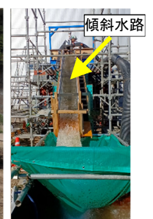
シェルネット型越流対策工を用いた越流実験の状況
