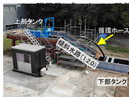
シェルネット型越流対策工を用いた越流実験の状況
