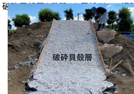
破碎貝殻層（厚さ10cm）の施工状況と越流実験の状況例
