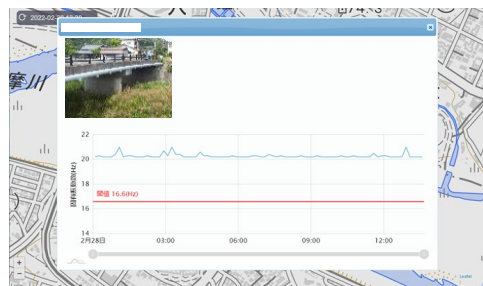
図2 振動数(洗掘量)の計測例
