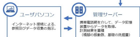
図1 洗掘モニタリングシステム
