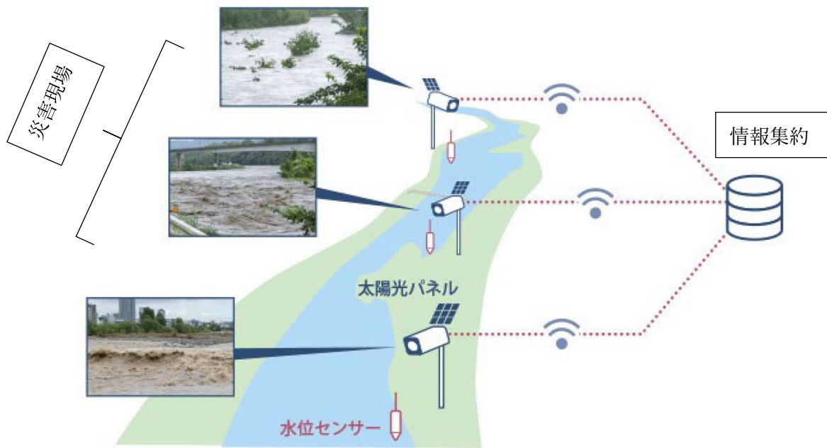
図2 監視カメラと水センサーによる河川のリアルタイム監視システム
