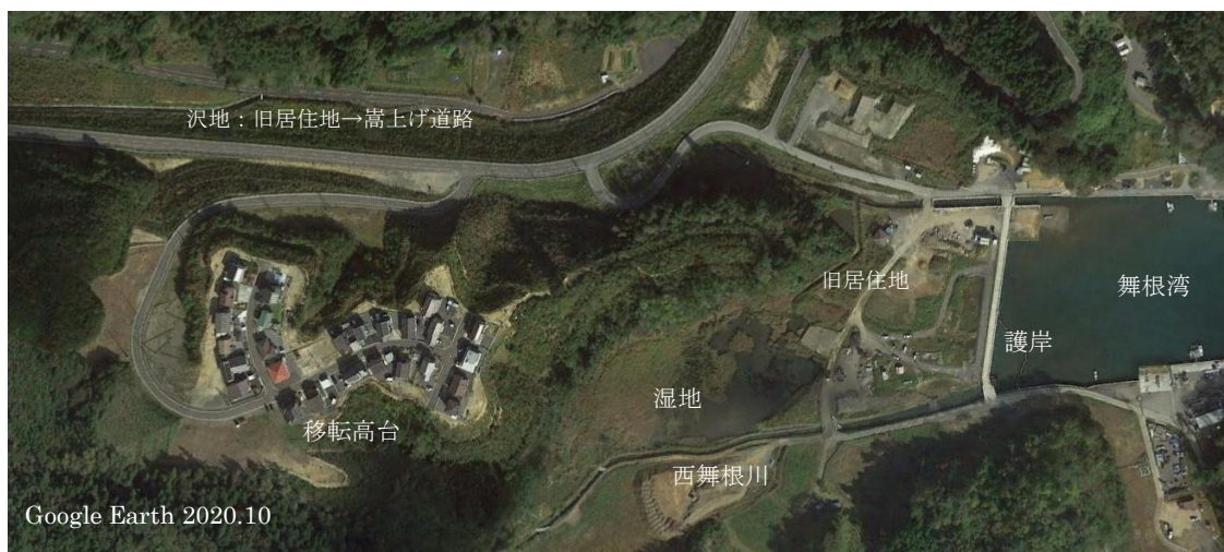
写真39-1 防潮堤を原形復旧して高台移転：気仙沼市舞根、Google Earthに加筆
