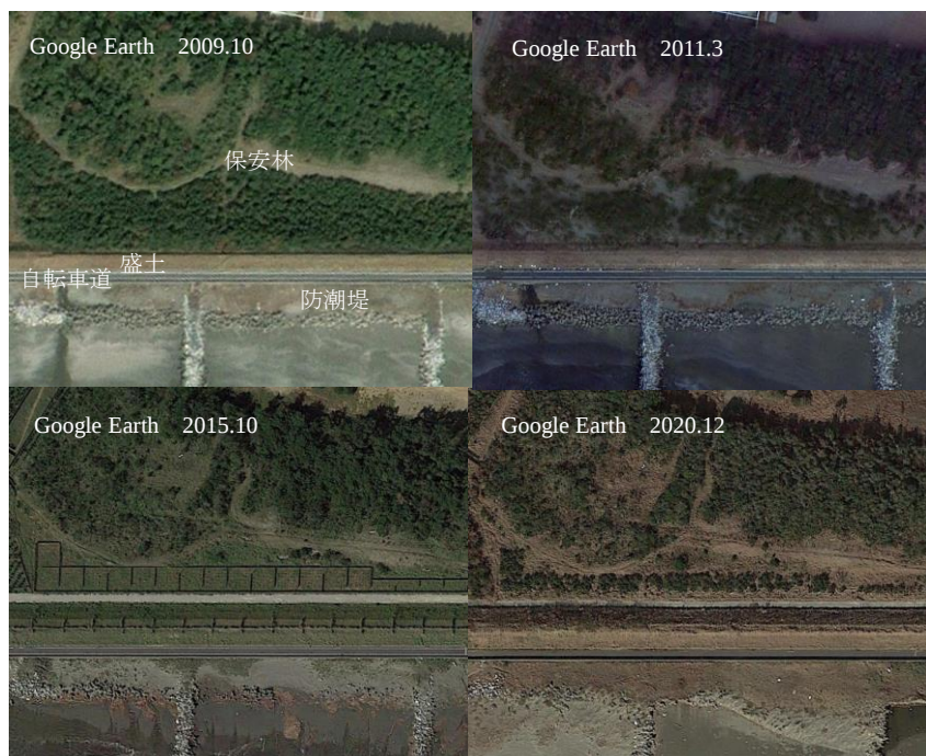
写真71-2 盛土、保安林、砂浜の変遷：千葉県旭海岸、Google Earthに加筆
