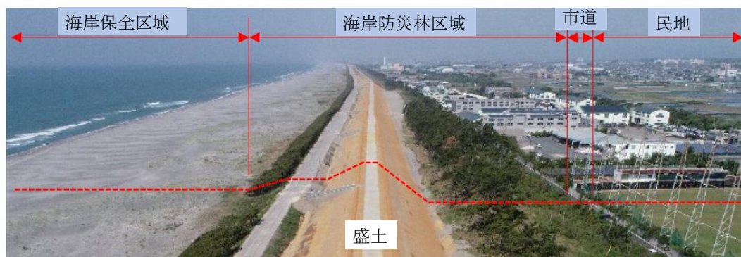
図39 盛土の防潮構造が整備された沿岸陸域のイメージ図：文献18 に加筆
