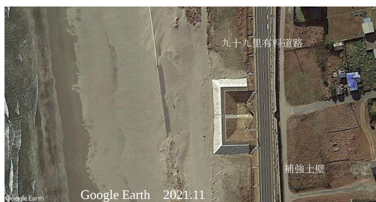
写真37-1 嵩上げ道路の海陸の横断構造：Google Earthに加筆
