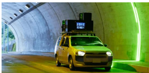
写真 11 トンネルモニタリング技術 31)
