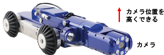
写真12 下水管内検査用TVカメラ車両（ソニー製）（著者加筆） 32)
