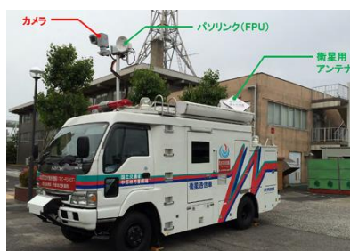
写真18 衛星通信車（国土交通省中部地方整備局）46)
