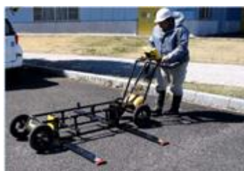
写真8 地中レーダによる探査風景(カート搭載型) 25)
