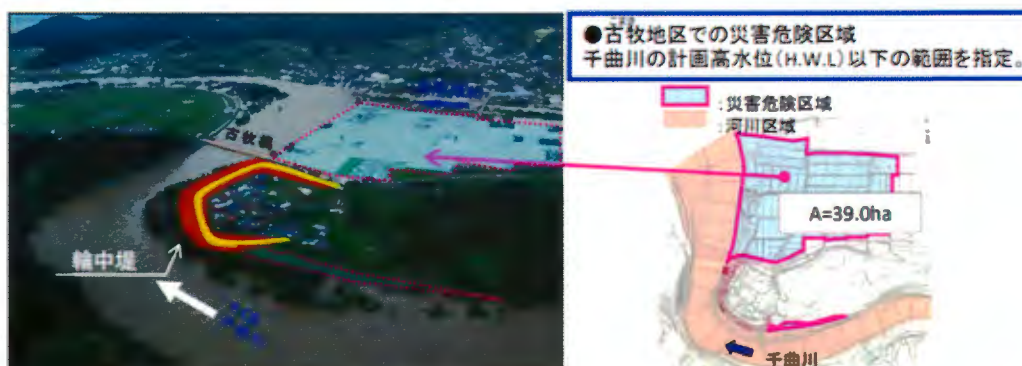
写真 6 千曲川の輪中堤による防御（2006.7 洪水） 41) （著者加筆）
