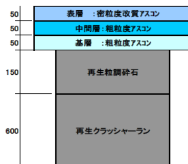
図-6 車道部、歩道部、宅地の構造的差異による被害の違い 5), 6)
