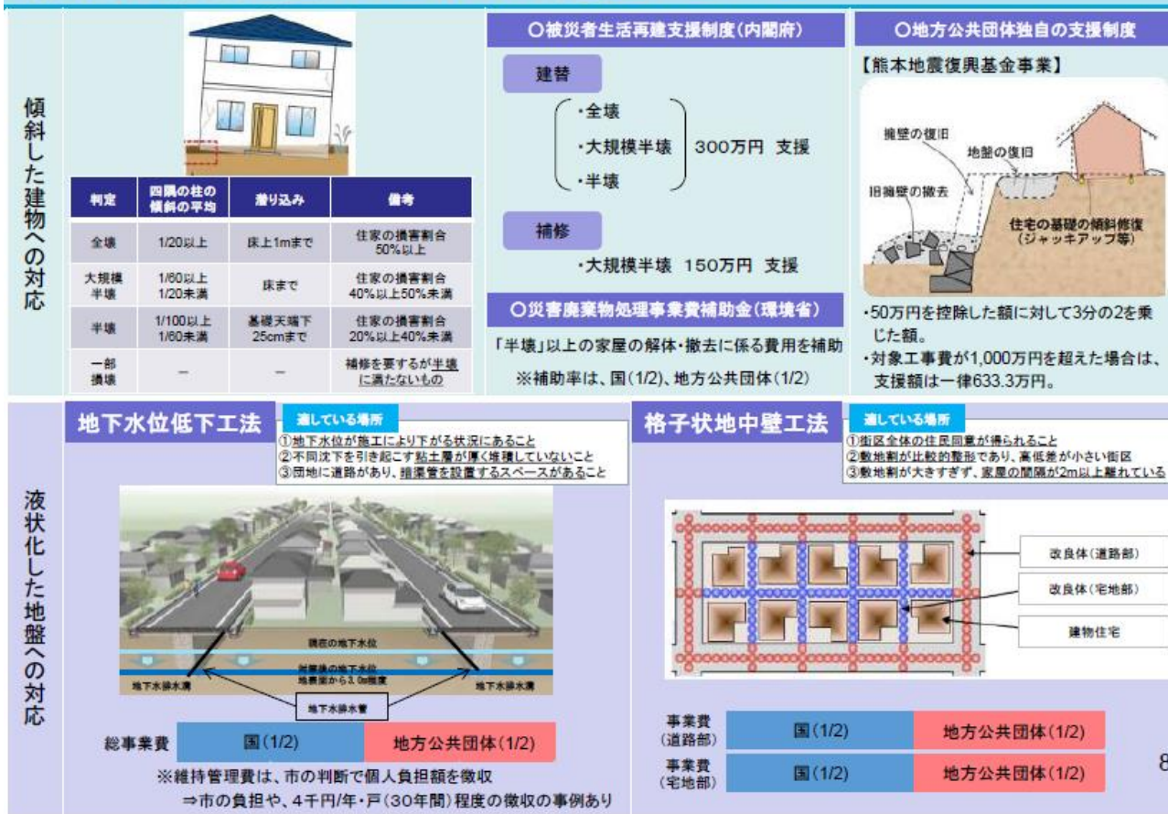
図-9 液状化被害を受けた宅地の復旧 7)
