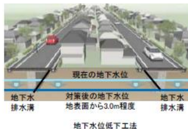
図-8 宅地耐震化推進事業（宅地液状化防止事業）の概要 7)
