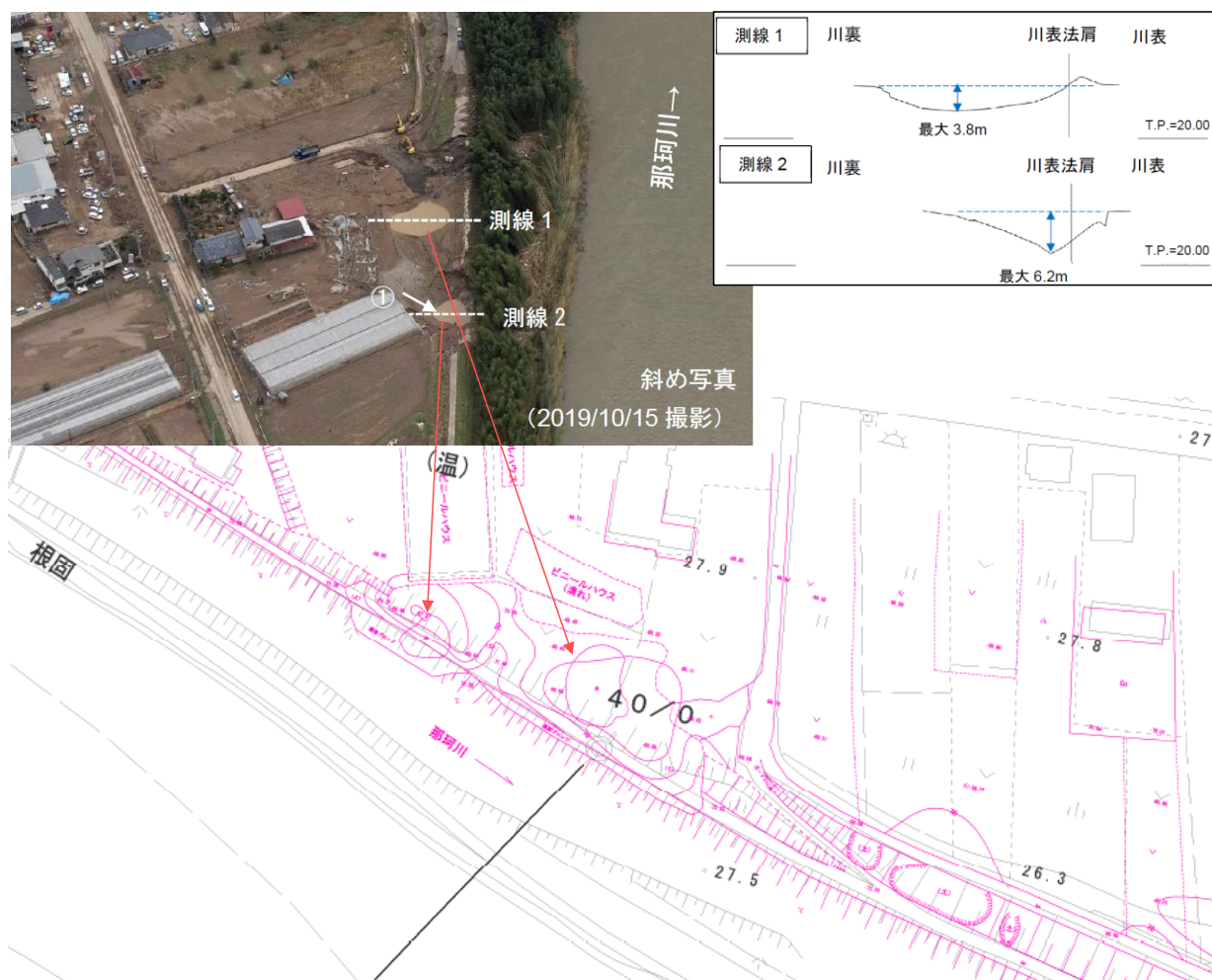
図 36 落堀の形成状況：那珂川左岸 40.0k、鬼怒川堤防調査委員会の資料：文献 28 に加筆
