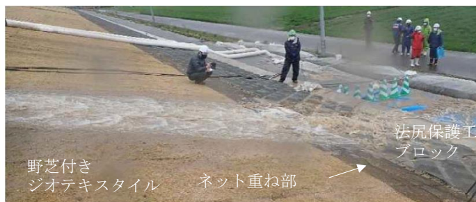
(b) 法尻通水状況：ケース 3、注）芝は冬枯れの状態
