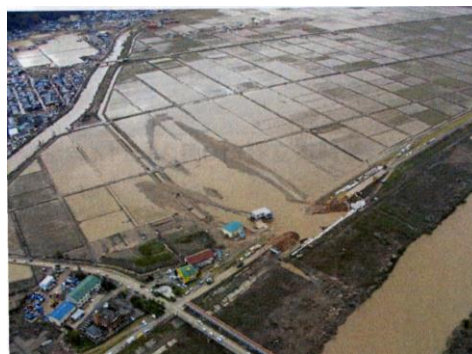
写真 1 円山川の立野地区の破堤状況：左・近景、右・全景 2)
