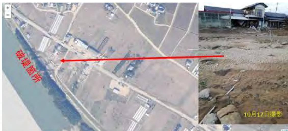
図1-1-2-8 常陸大宮市野口地区の破堤堆積物の状況
