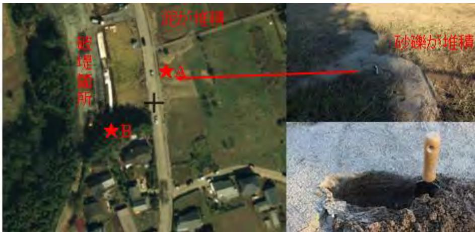
図 1-1-1-5 常陸大宮市富岡の破堤地点周辺の堆積物の状況
