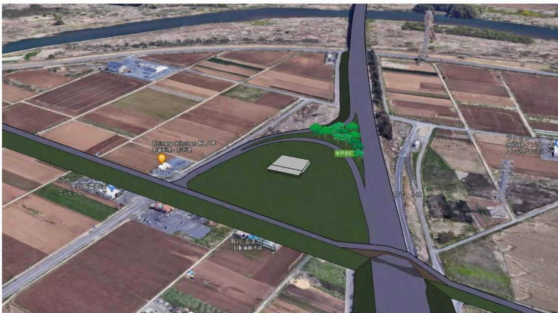
図 3-7 水戸北スマート IC と国道 123 号の嵩上げイメージ
