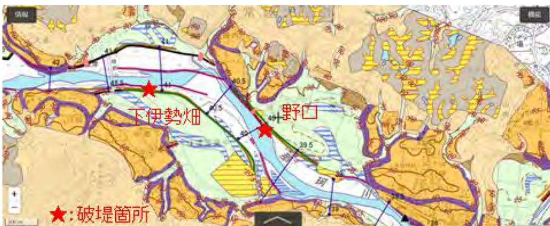
図1-1-2-7 常陸大宮市内的那珂川の破堤箇所(背景は国土地理院の治水地形分類図)
