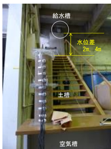
写真-26 越流水位による土層の浸透特性の 屋内模型実験
