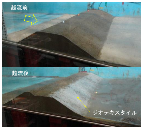
写真-28 盛土のジオテキスタイル敷設による侵食防止実験
