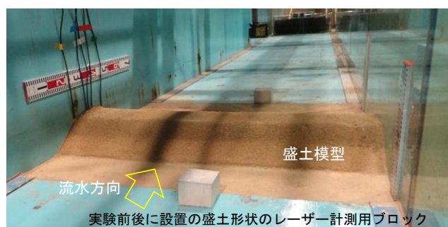
写真-27 水路および盛土模型：水路模型実験による検証
