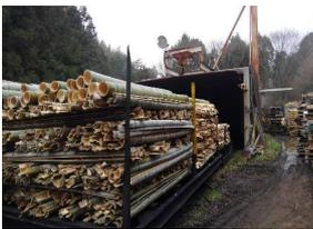
台車に積み上げた状態で炉内へ
